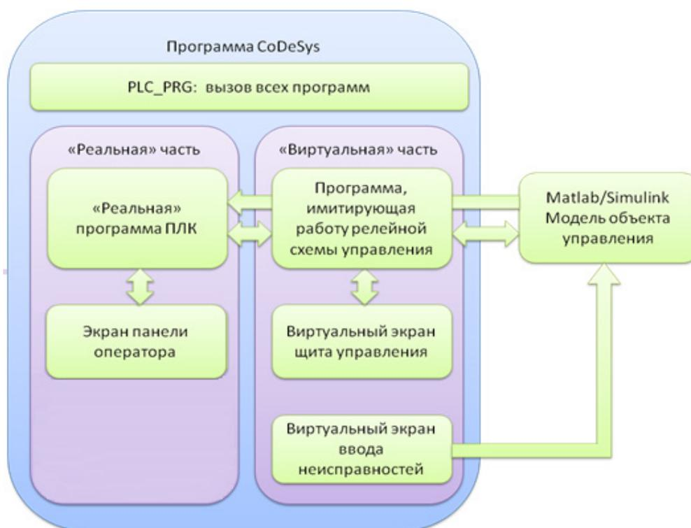
Рис. 2. Структура имитационной системы.
