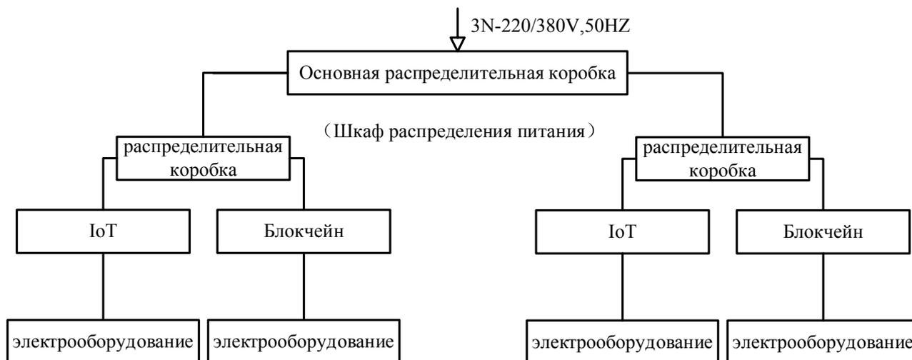
Рис. 2. Структурная схема трехуровневой интеллектуальной системы распределения электроэнергии.
