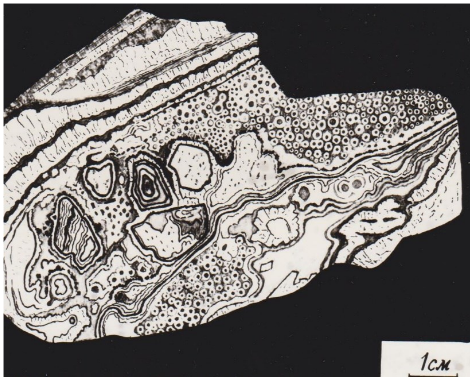
Рис. 2. Текстуры адуляр-кварцевых руд Кубакинского золотосеребряного месторождения, меняющиеся от полосчатой и кокардовой до сферолитовой. Зарисовки штуфа.
