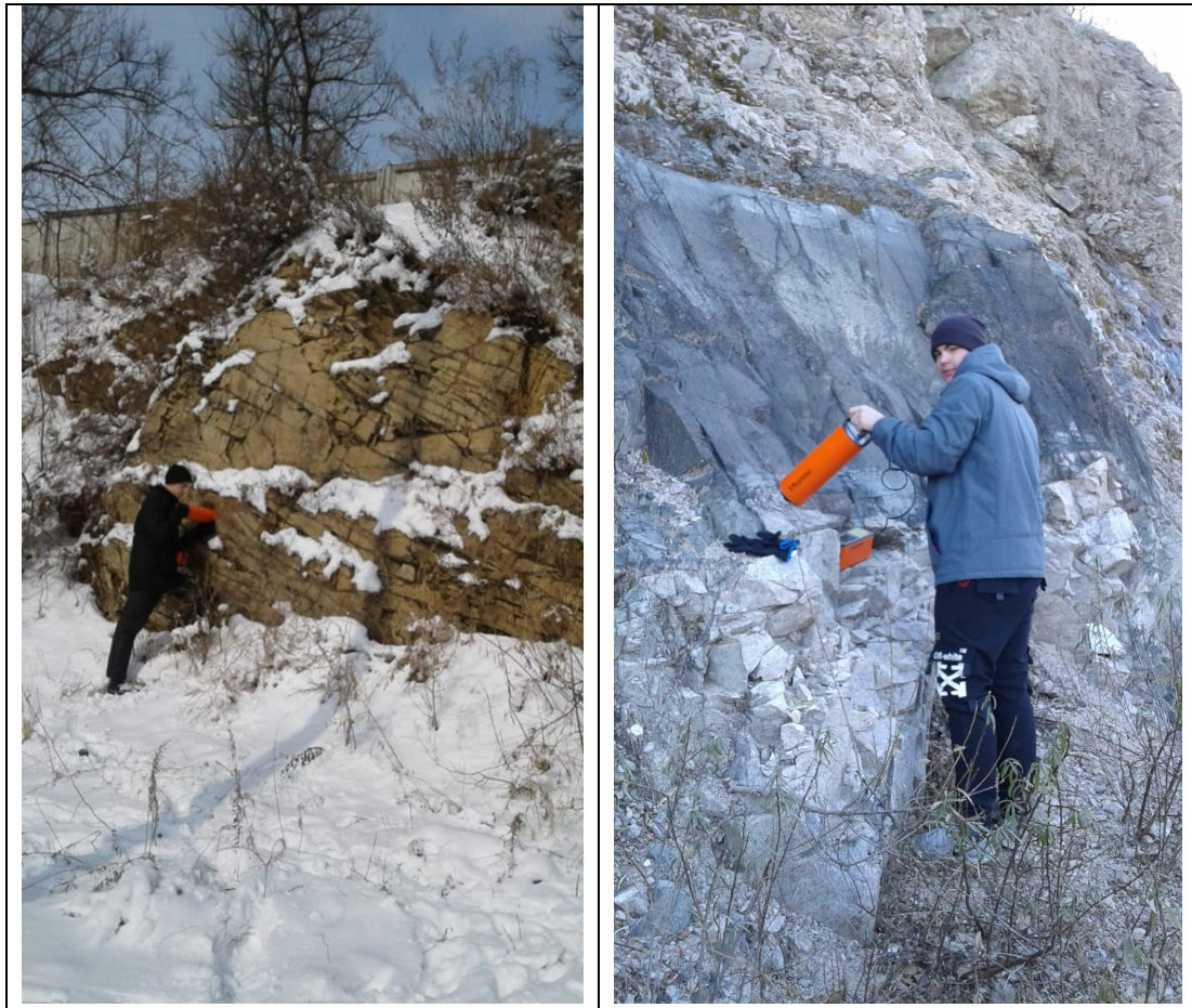
Рис. 2. Проведение замеров гамма-спектрометром GS-512i.
