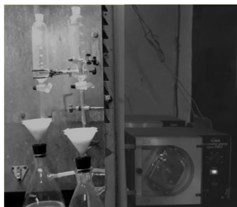
Рис. 2. Комплект оборудования для фильтрования с использованием перистальтического насоса.
