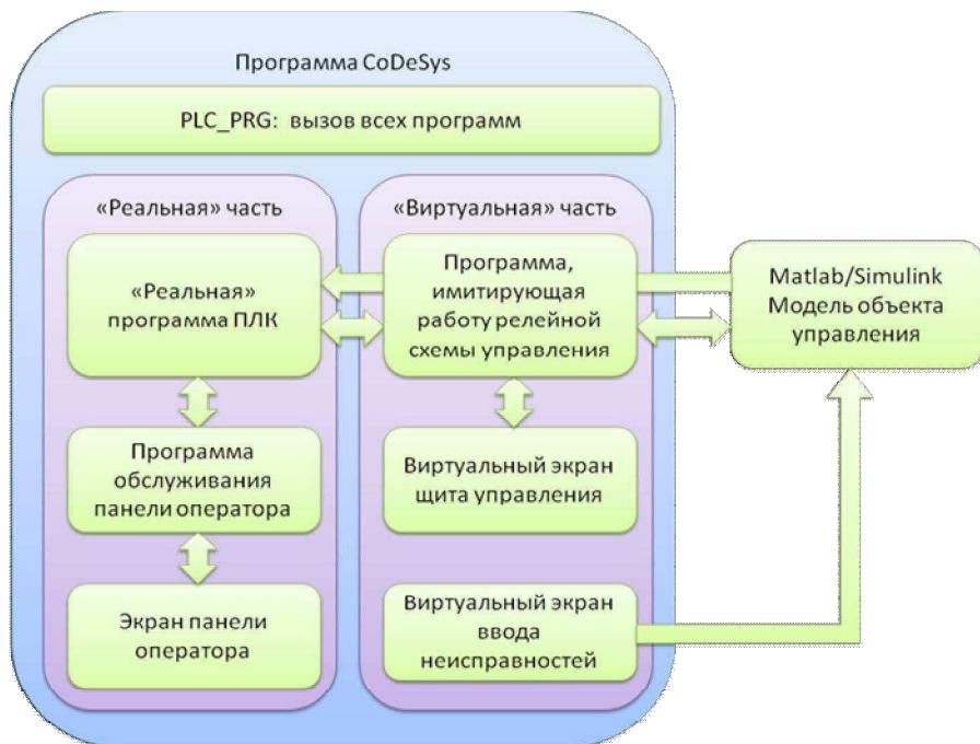
Рис. 6. Структура программного комплекса.
