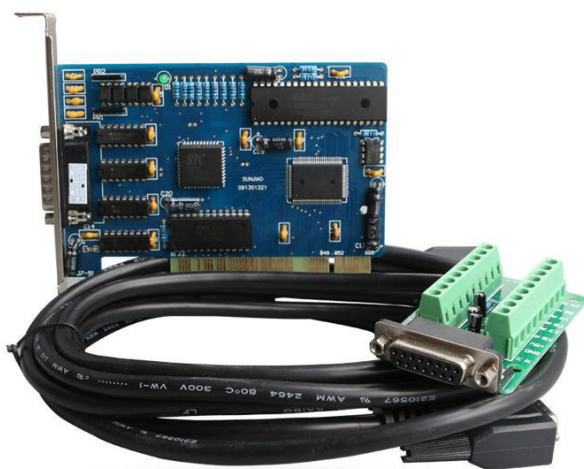
Рис. 2. Комплектация ЧПУ-контроллера NC Studio.
