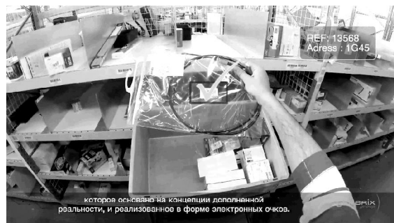
Рис. 3. Идентификация линейного штрихового кода с помощью smart-очков.
