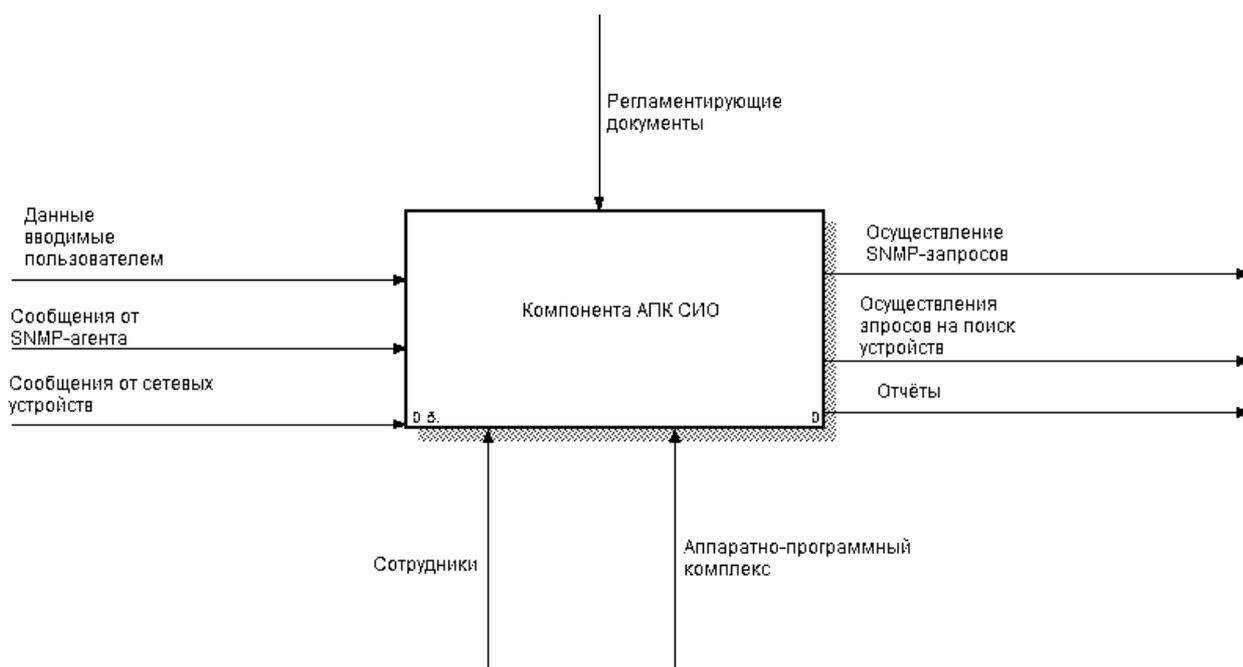
Рис. 1. Диаграмма взаимодействия компоненты со внешними устройствами.
