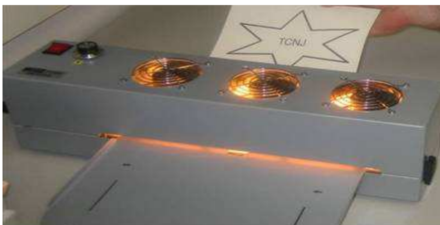
Рис. 5. Рельефообразующий аппарат, формирующий рельефный бумажный оттиск.
