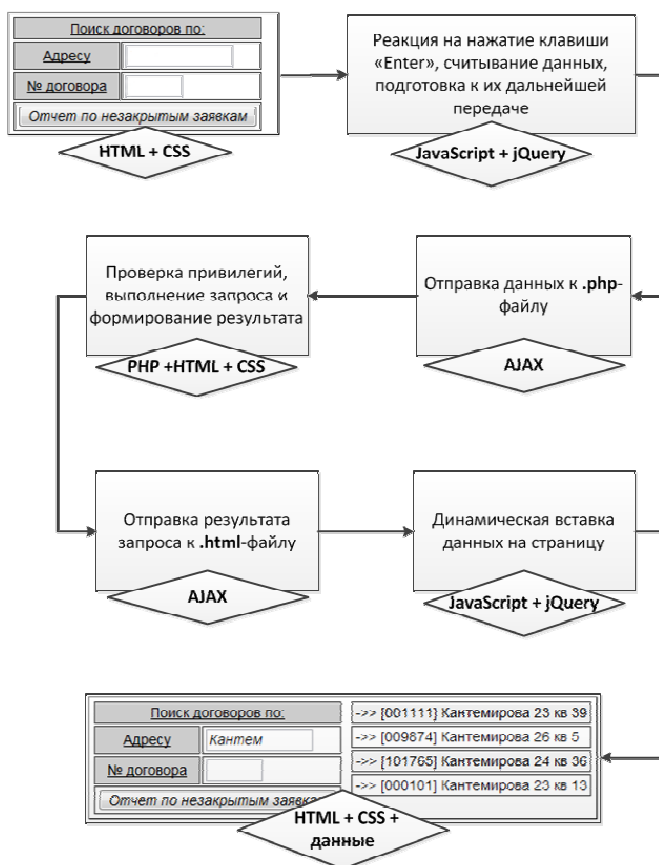
Рис. 3. Схема взаимодействия средств разработки системы.
