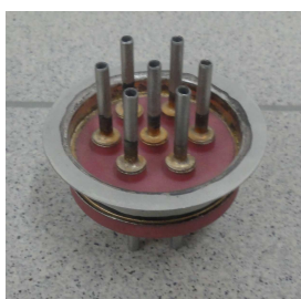
Рис. 2. Многостырьковый керамический проходной изолятор.
