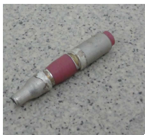
Рис. 1. Одноштырьковый металлокерамический проходной изолятор.
