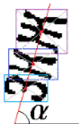
Рис. 5. Результат поворота надписи на угол, найденный по построенной прямой.
