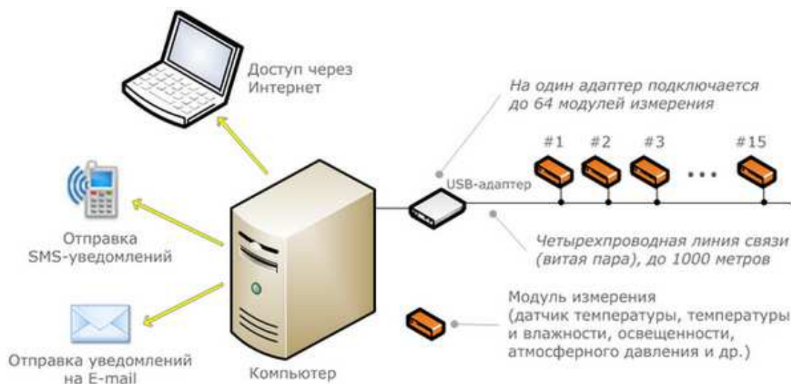
Рис. 2. Устройство системы «Страж-Климат».
