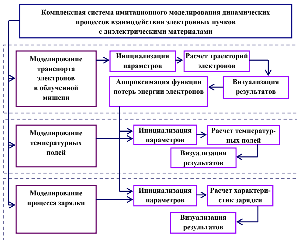
Рис. 1. Структура программного комплекса моделирования динамики инжекционных и тепловых процессов взаимодействия электронных пучков с диэлектрическими материалами.
