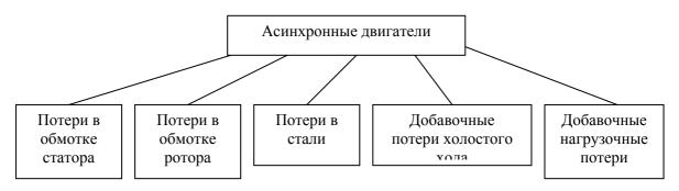
По конструктивному признаку потери от низкого КЭ в элементах систем электроснабжения можно структурировать следующим образом (рис. 2, 3).
