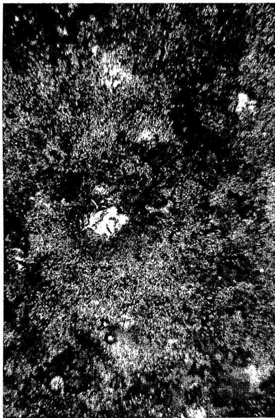
Рис. 4. Поверхность ВК8 после ЭИЛ карбидом титана (x800).
