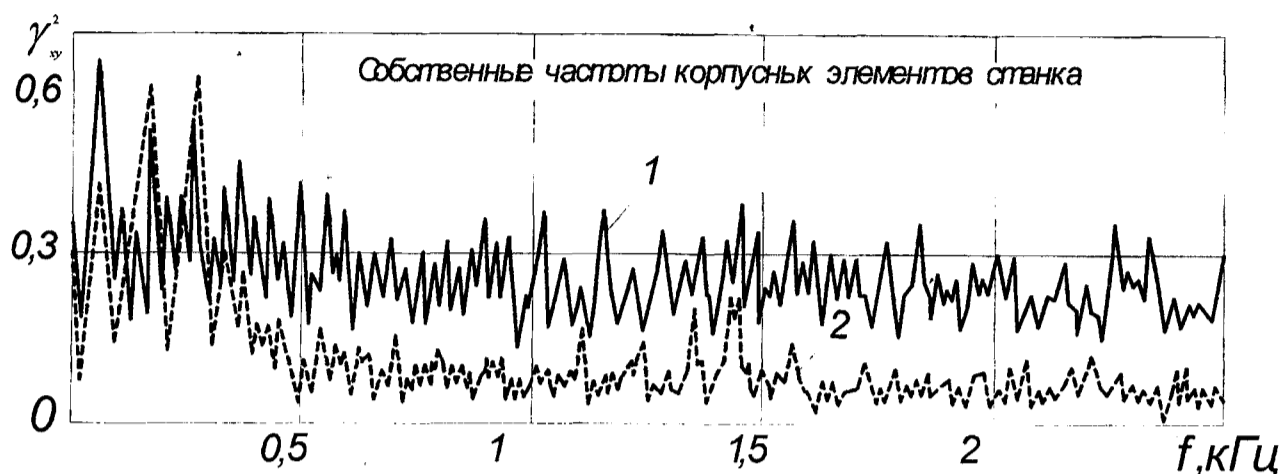
Рис. 7. Функции когерентности виброускорений вертикально-сверлильного станка мод. 2Н135.
